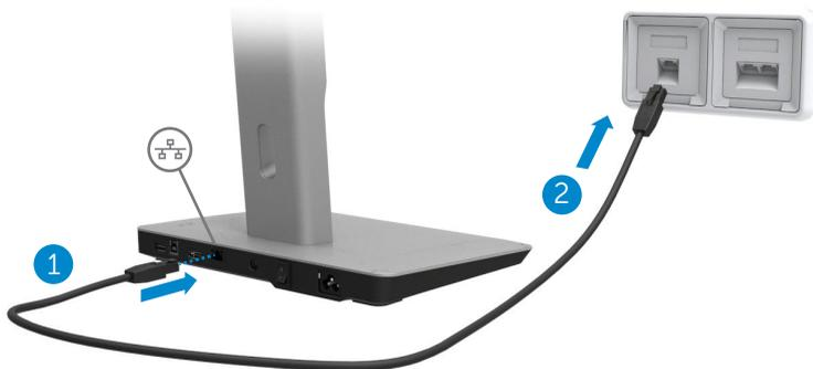
**N.B.:** il connettore RJ-45 (rete) del computer è disabilitato quando il computer è connesso al piedistallo di alloggiamento.
